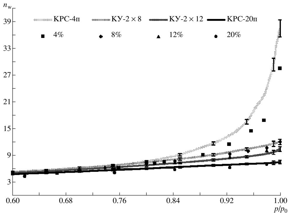
Рис. 3. Изотермы сорбции (точки) и десорбции воды (линии) для сульфокатионитов в  $\text{H}^+$ -форме с 4 [14], 8 [13], 12 и 20% ДВБ [15].
