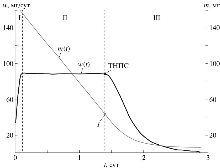
**Рис. 1.** Зависимости массы воды в ячейке ( $m(t)$ ) и скорости сушки ( $w(t)$ ) от времени эксперимента ДДП. Пунктиром обозначены границы этапов сушки;  $I$  – масса “связанной” воды. Обозначения – в тексте.
