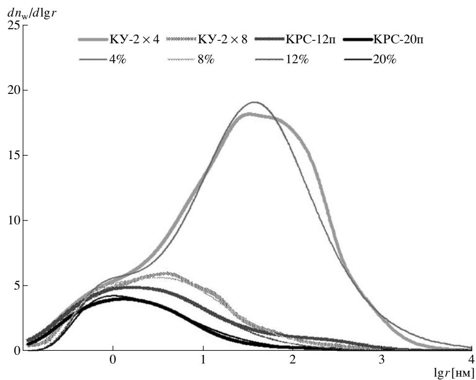
Рис. 4. Изотермы десорбции воды из сульфокатионитов в  $\text{H}^+$ -форме в координатах распределения пор по радиусам. Толстые линии – распределения, полученные в экспериментах, тонкие – модельные распределения, рассчитанные из зависимости активности воды от концентрации в растворах мономера.
